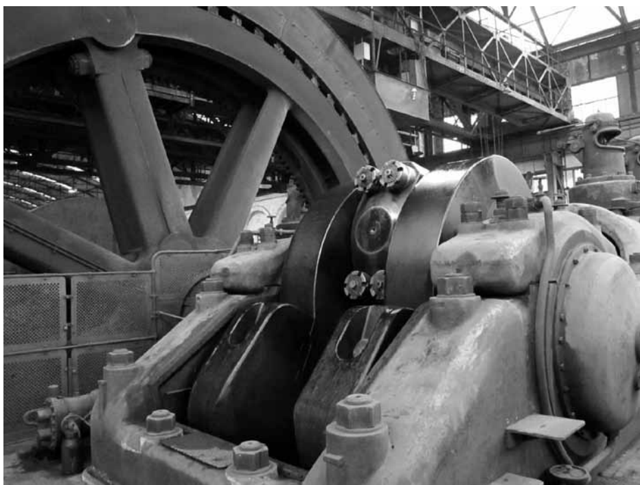
Die Gasmaschine mit ihrem Schwungrad von 11 Metern erbrachte schon eine beträchtliche Leistung.
