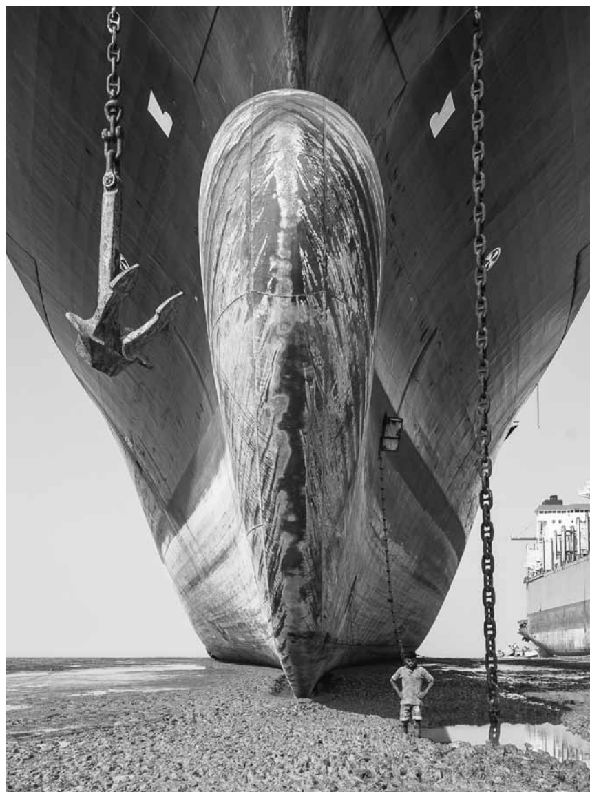
Hoher Gezeitenhub, weicher Grund und nicht zuletzt Arbeiter, die ihr Leben riskieren, bieten optimale Voraussetzungen, Ozeanriesen auch ohne komplexe Werftanlagen zu demontieren.
