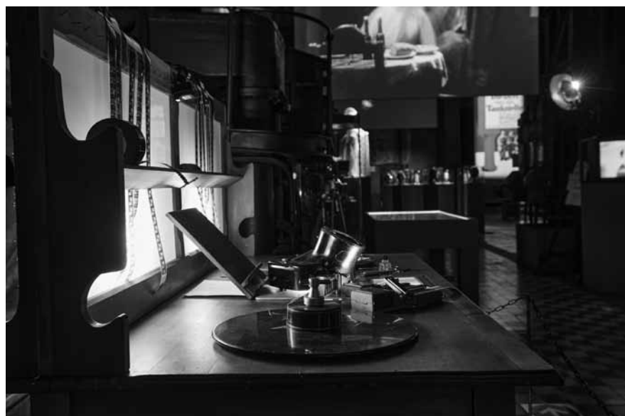
Auch technische Geräte haben in der Schau ihren Platz, so etwa der weltweit erste Schneidetisch für die Filmmontage – der Lyta-Universal-Arbeitstisch.
